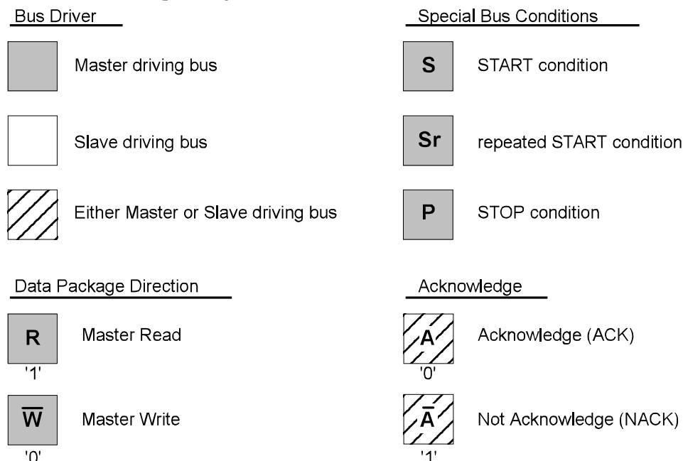
**Figure 33-3. Basic I<sup>2</sup>C Transaction Diagram**
